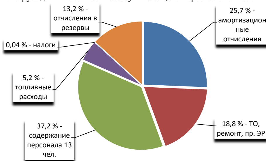
Рис. 4. Укрупнённая структура эквивалентной себестоимости ядерного энергоисточника мощностью 100 кВт эл., при капитальных затратах 337 млн. руб. и численности обслуживающего персонала 13 чел.
